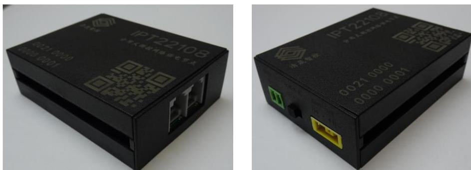
图 5 能源管理系统测控节点组件
